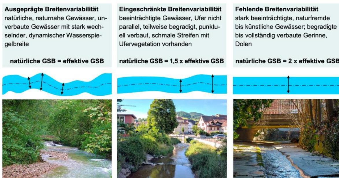
Abbildung 9: Korrekturfaktoren zur Ermittlung der natürlichen Gerinnesohlenbreite
